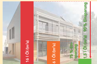
Gebäudebestand Neubau nach EnEV 2009 Passivhaus
