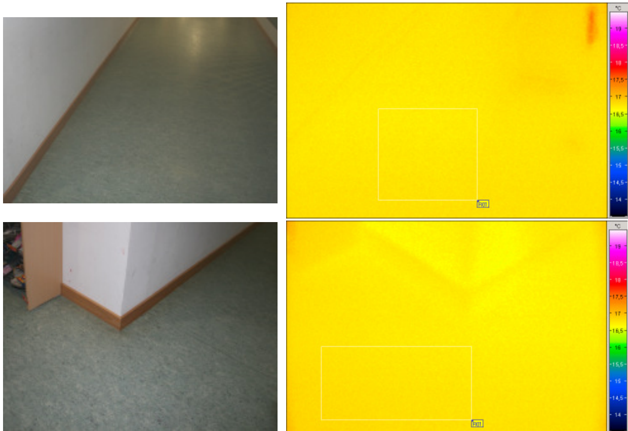
Abbildung 31: Thermographien der Fußbodenoberfläche im Flurbereich vor Raum 0.3 am 07. Januar 2008 mit den zugehörigen Fotos.
