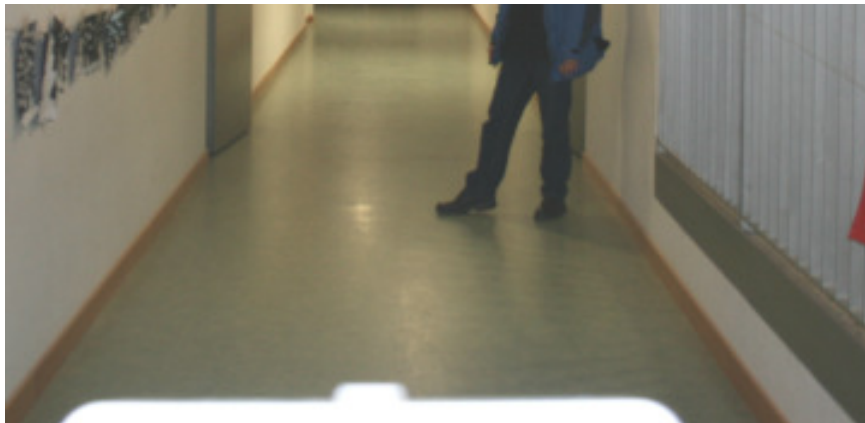
Abbildung 29: Spiegelung einer Person und der Deckenlampen auf der Fußbodenoberfläche im Flur der Riedbergschule in der Thermographieaufnahme mit dem zugehörigen Foto.
