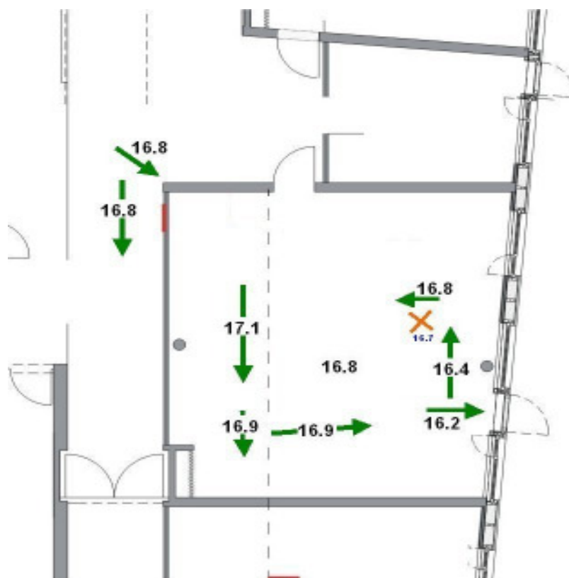
Abbildung 32: Ergebnisse der Oberflächentemperaturmessungen im Raum 0.3 und im Flur davor. Die Pfeile geben die „Blickrichtung“ der Thermographiekamera an, bei den Zahlenwerten handelt es sich um die gemessenen Temperaturwerte in °C. Das orange Kreuz markiert den Bereich der Oberflächenmessung mit dem Datenlogger. Der Temperaturwert unter dem Kreuz stellt den mit der Thermographie festgestellten Messwert im Bereich direkt neben der Datenloggermessung dar.
